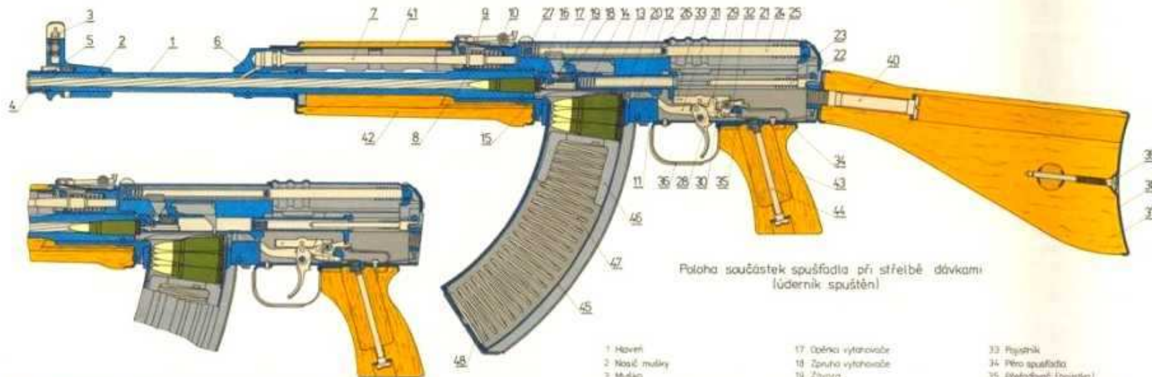
Poloha součástí spouštěcího mechanismu při střelbě jednotlivými ranami (úderník napnut)
