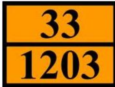
Obrázek 4 Příklad označení cisterny přepravující vysoce hořlavou látku (Kemler kód: 33), konkrétně benzín (UN číslo: 1203)
